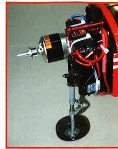
Pour le montage du XC4220/14, les colonnes destinées au Topfly sont idéales. Un bâti plus rustique est aussi fourni dans le kit.
