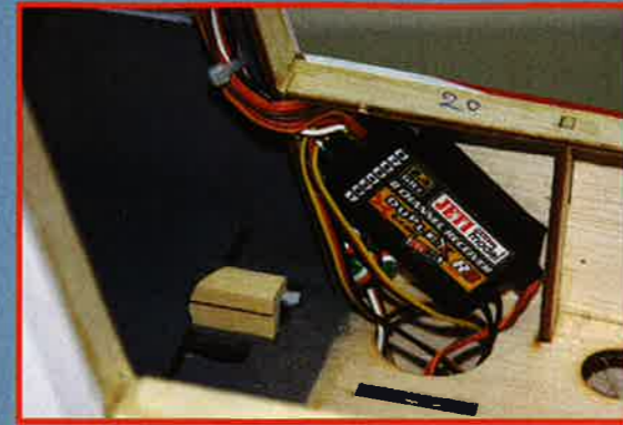
Pour laisser la place au pilote et à l'accu de propulsion, le récepteur a pu être logé dans un flanc du fuselage. Les fils partant vers les ailes sont regroupés en faisceau le long du couple.
