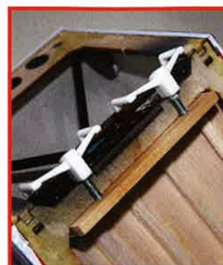
L'auteur a collé une baguette sous le tableau de bord, traversée par des vis de 3 mm sur lesquelles se vissent les volants.
