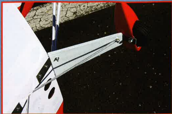
Les tubes alu ont été ajoutés par l'auteur pour figurer les tirants de la suspension du grandeur.
