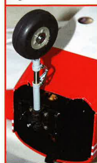
La jambe de train suspendue et habillée ajoute beaucoup au look du modèle et est fournie dans le kit.
