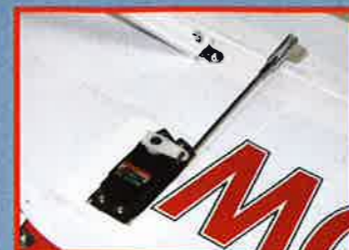
Les commandes très courtes sur les servos de volets et d'ailerons.
