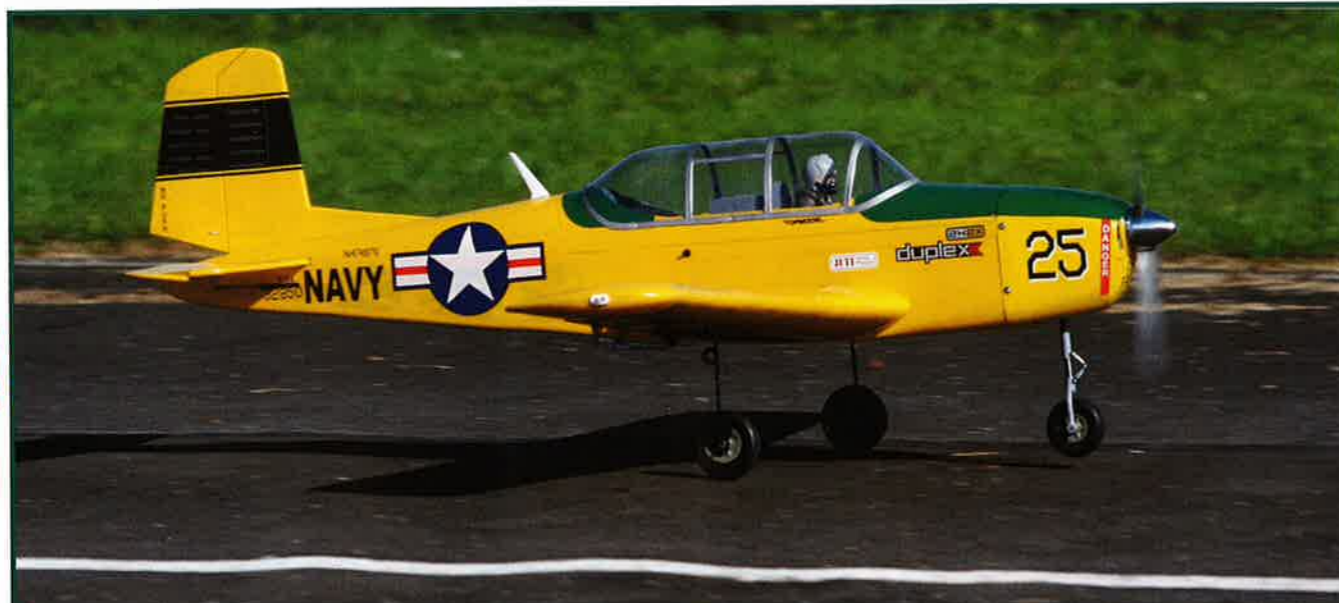
Le logement de la roulette avant rétractable est parfaitement prévu d'origine. Pas de retouche notable à faire.
