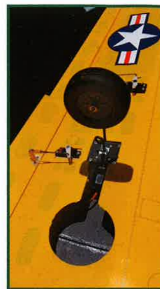
Le guignol de volet monté tourné vers l'arrière est favorable à la cinématique de la commande.
