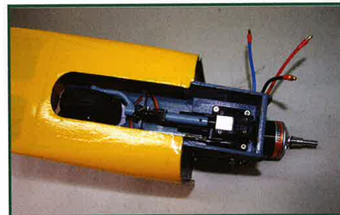
Le logement de la roulette avant rétractable est parfaitement prévu d'origine. Pas de retouche notable à faire.
