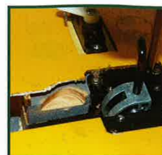
On voit ici le lamage qu'il est impératif de réaliser si l'on installe le train rétractant, pour que la boucle sur la jambe ne bute pas.
