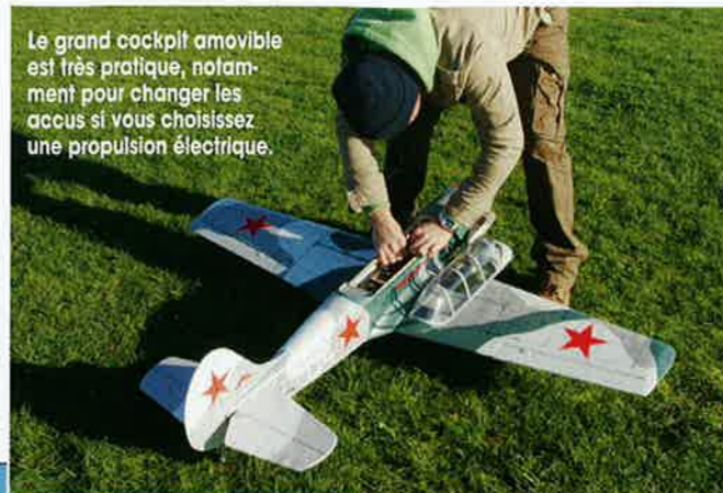
En configuration d'origine, le Yak 52 TW a tendance à passer sur le nez sur piste en herbe. On pourra mettre des roues de plus grand diamètre pour limiter le phénomène.
